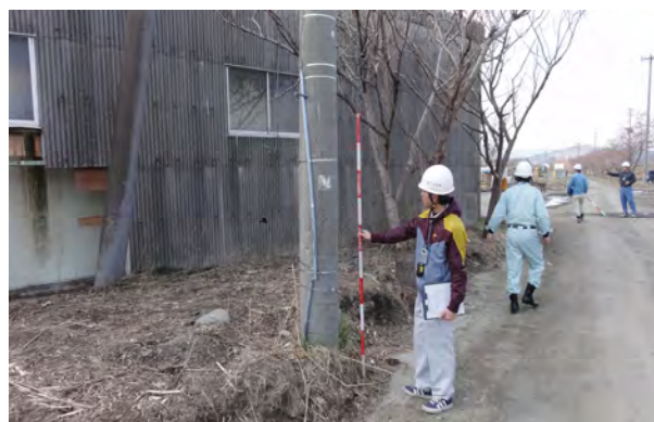
写真 2.1.1-2 電柱や桜の幹に津波痕跡 1.8m
