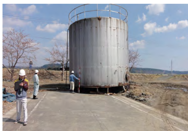
写真 2.1.1-4 鋼製の石油タンクの漂流物
